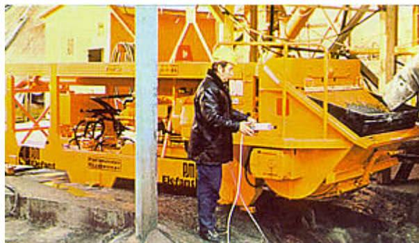
PM-Elefant BRS 2104 E mit 132 kW-Elektomotor
